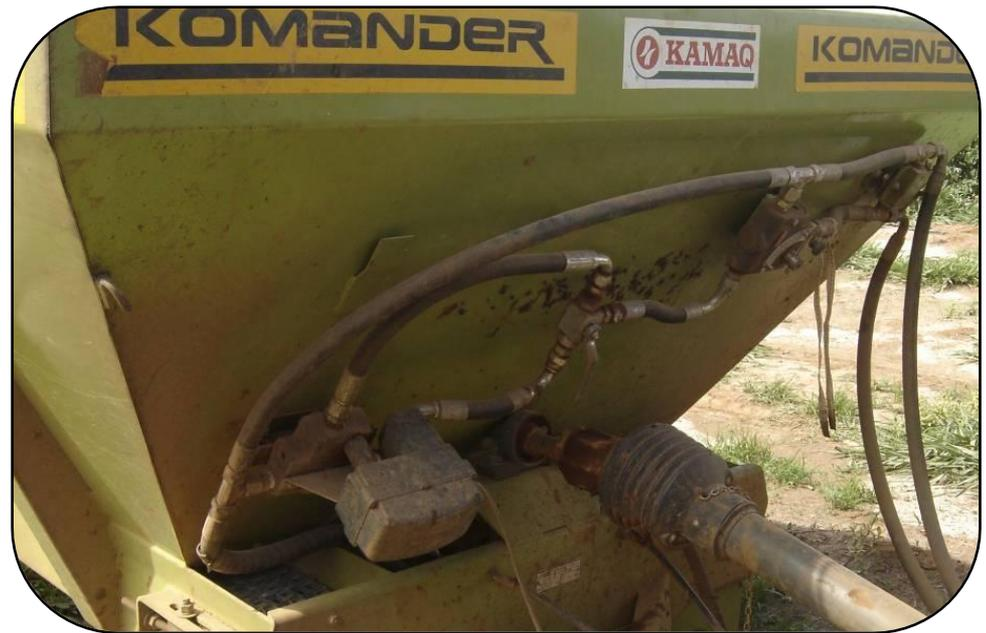
Válvula hidráulica que controla a velocidade da esteira
